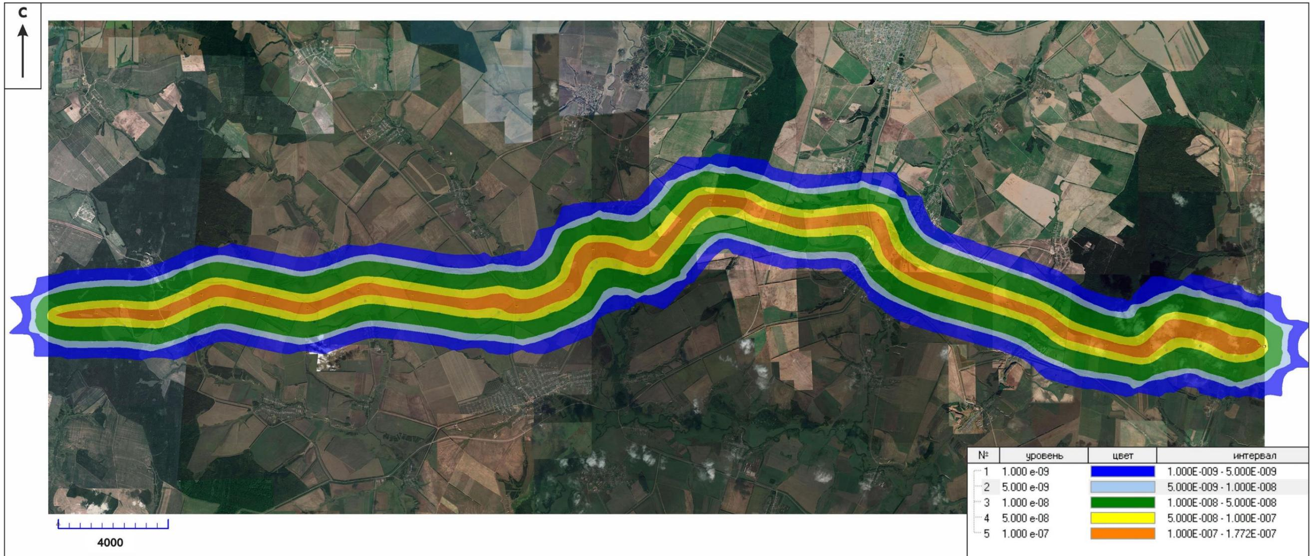
Рисунок 14 – Поле потенциального риска при авариях на трассе этиленопровода при 1 состоянии (лист 3)
