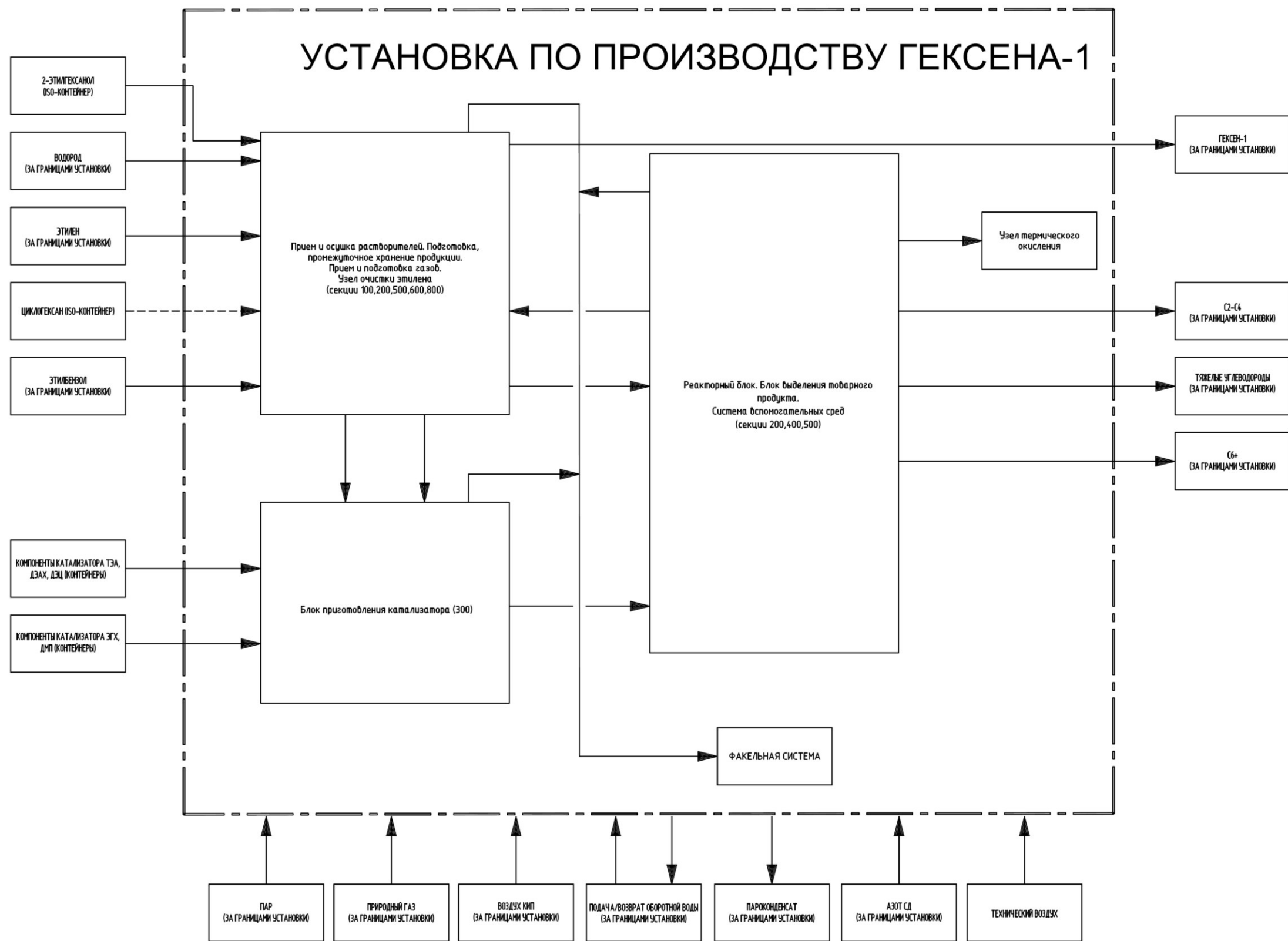
Рисунок 3.1 – Блок-схема установки получения гексена-1
