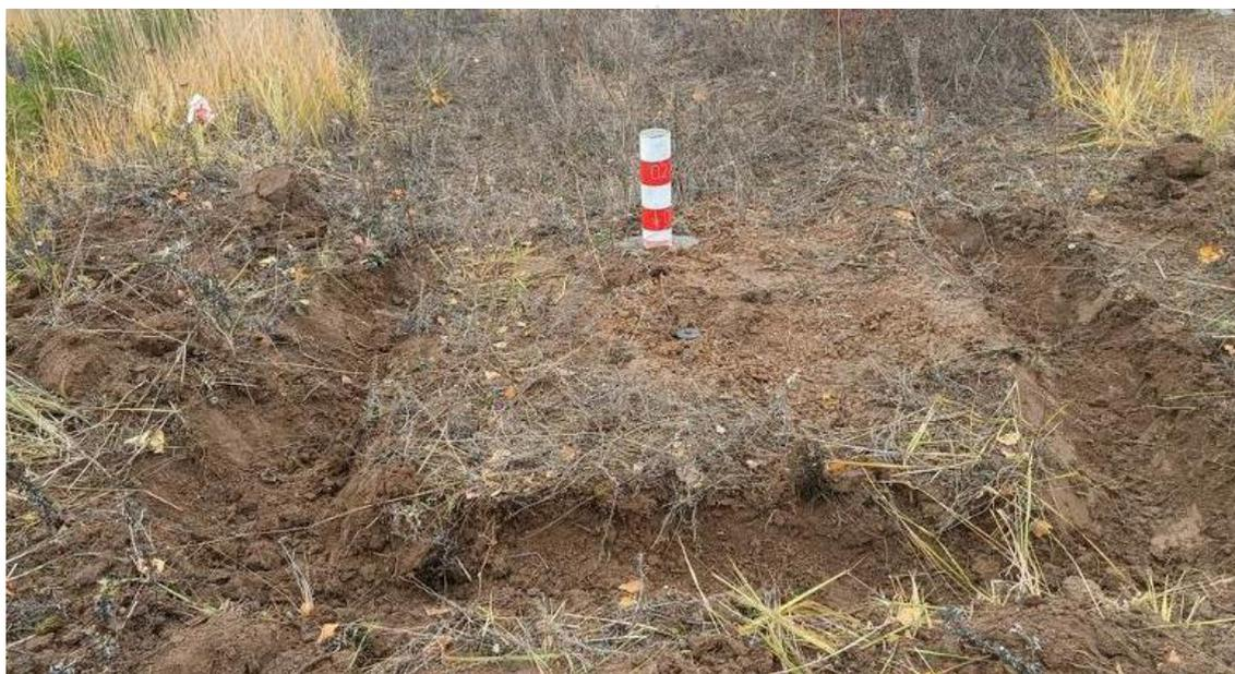
Рисунок 1 – Существующие пункты ОГС: сверху - эскиз пункта ОГС, тип центра 155 ОП; снизу – фото одного из пунктов, заложенных ООО «Аэрогеоматика» в 2023 г.
